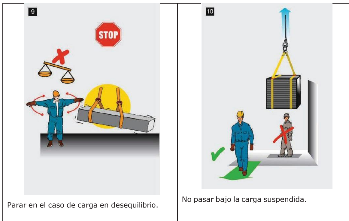
Figura 19: Izado de cargas 3
