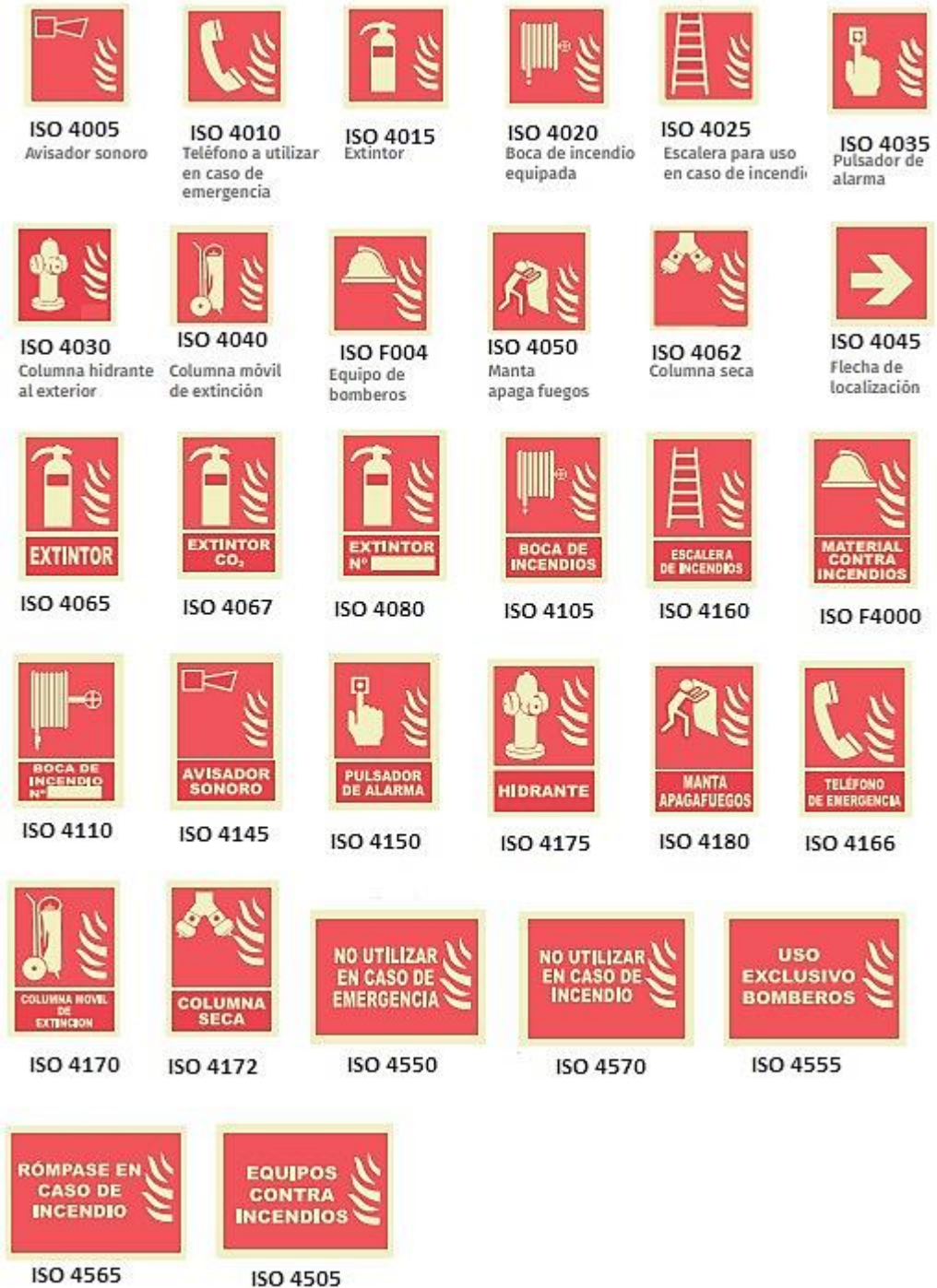
Figura 10: Señales de lucha contra incendios
